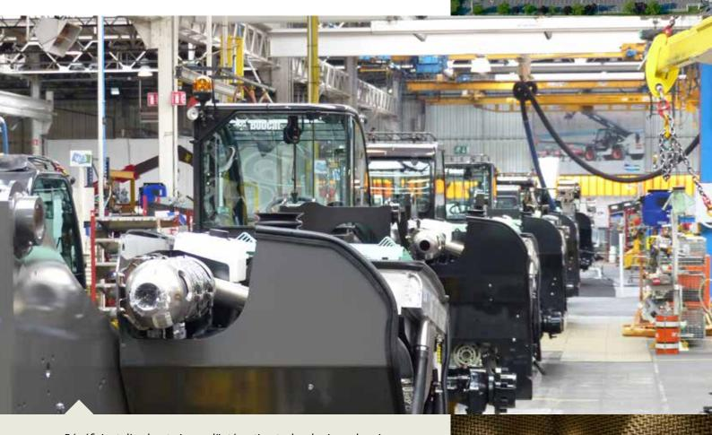
Bénéficiant d'un haut niveau d'intégration technologique depuis le soudage de la flèche et du châssis jusqu'à l'assemblage final des machines, notre productivité et la qualité de nos produits sont assurées par un équipement de production moderne comprenant des robots de soudage, une ligne de grenaillage, une cabine de peinture à deux couches, ainsi que par une méthode d'intégration des meilleurs composants.
